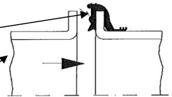
3. Das Gegenrohr mittig in gleichmäßiger Flucht an die Bördelkante mit dem aufgezogenen Bördeldichtring ansetzen und Passung kontrollieren.
