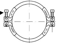
6. Der Zuganker (gelb verzinkt oder Edelstahl) ist mit zwei Rillen versehen. Diesen aus dem Spannschuh aushaken und die zwei Spannringhälften um den drehbaren Zuganker öffnen. Der gesamte Spannring bleibt dafür inklusive der Spannschrauben als eine Einheit zusammen.
