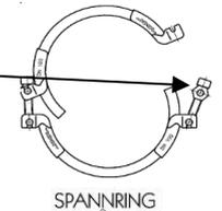
7. Den Spannring in geöffnetem Zustand um beide Bördelkanten der zusammenzufügenden Rohrteile legen, den Zuganker einhängen und beide Spannschrauben gleichmäßig bis zu einem Drehmoment von 10 Nm mit einem Sechskantschraubendreher anziehen.
