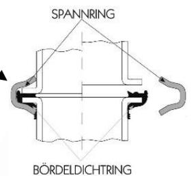
**Achtung:** Beim Schließen des Spannringes darf der Bördeldichtring keine Schlaufen bilden.
