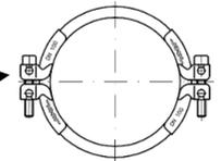
5. Beide Spannschrauben lösen, aber nicht ganz aus dem Spannelement herausdrehen.
