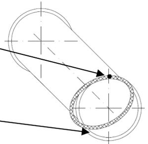
2. Nun den Bördeldichtring komplett unter leichter Längendehnung aufziehen (Dehnung ist nötig, aber **nicht zu sehr in die Länge ziehen**, dies würde zu Undichtigkeiten führen).
